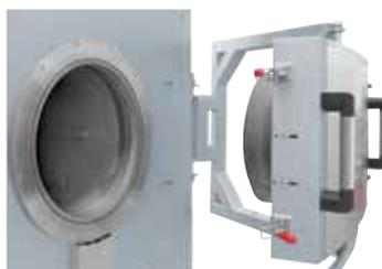
Porta ad apertura parallela per apertura del forno a storta a camera calda come dotazione aggiuntiva
