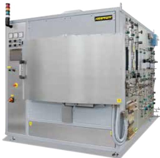
Forno a storta NRA 300/09 H<sub>2</sub> per il trattamento termico con idrogeno
