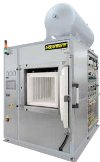
Forno a storta VHT 100/15-KE H<sub>2</sub> con isolamento in fibra con pacchetto di ampliamento per il funzionamento con idrogeno, 1500 °C
