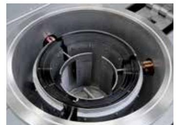
Storta cilindrica con riscaldamento al tungsteno
