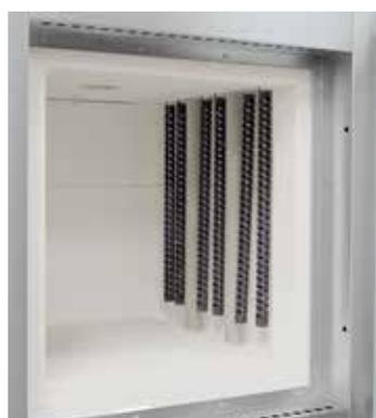
Barre in SiC montate verticalmente e tubi perforati opzionali per ingresso aria del sistema di deceraggio in un forno ad alta temperatura
