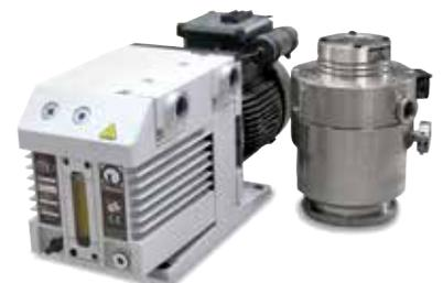
Pompa turbomolecolare con pompa di prevuoto per trattamenti termici sottovuoto fino a 10<sup>-5</sup> mbar
