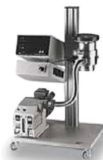
Pompa sottovuoto per funzionamento fino a  $10^{-5}$  mbar
