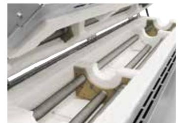
Forno tubolare RSH 120/1000/11S, controllo a tre zone, incl. separatori di zona per raggiungere un gradiente di temperatura
