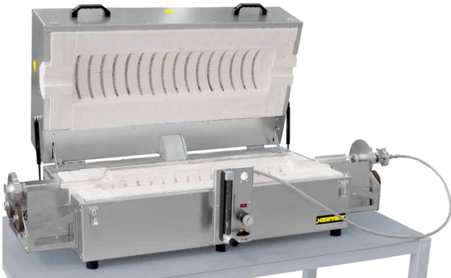
Forno tubolare rotante RSRB 120/750/11 come modello da tavolo per funzionamento batch
