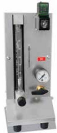
Sistema di gasaggio per gas inerte o di reazione non infiammabile con rubinetto di intercettazione e flussometro con valvola di regolazione, dotato di tubazione pronta per l'attacco
