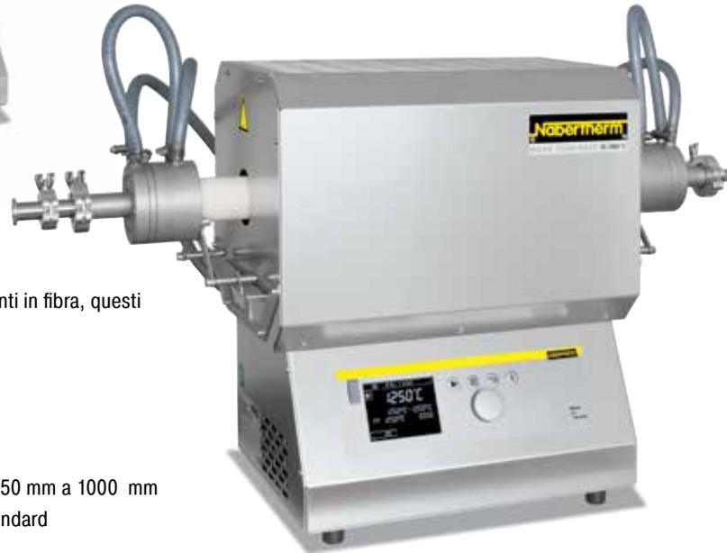
Forno tubolare R 50/250/13 con pacchetto di gasaggio 2
