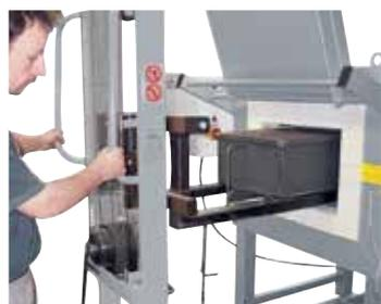
Lavoro con cassetta di cottura per l'atmosfera gassosa protettiva mediante l'ausilio di un carrello di carico
