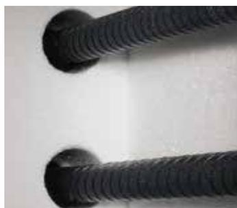
Camera forno con materiale in fibra pregiata e barre di riscaldamento SiC ai due lati
