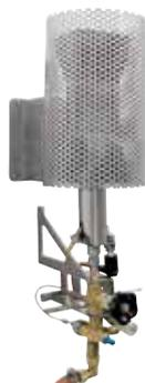
**Bruciatore a torcia** per la post-combustione dei gas di scarico. Il bruciatore a torcia è riscaldamento a gas e alimentato a gas propano. È consigliato per i processi in cui non è possibile utilizzare un catalizzatore.
