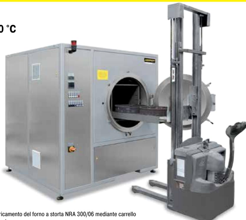
Caricamento del forno a storta NRA 300/06 mediante carrello elevatore
