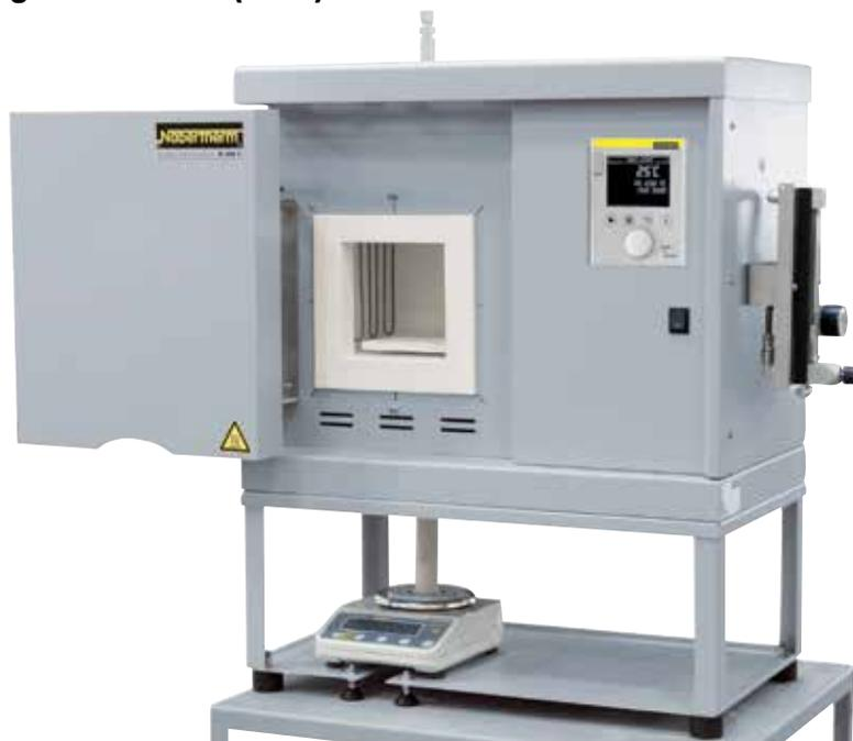
Forno ad alta temperatura LHT 04/16 SW con bilancia per determinare la perdita di peso e sistema di gasaggio
