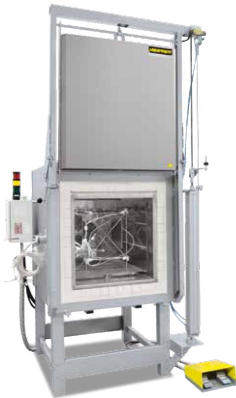
Supporto di misurazione per la determinazione dell'uniformità della temperatura
