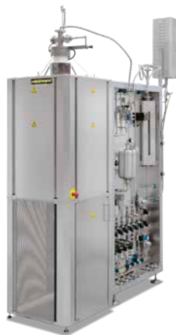
RHTV 120/600/17 H 2 con pacchetto di gasaggio 4 per gas infiammabili, gancio orientabile per appendere la carica e porta di sicurezza davanti alla flangia inferiore
